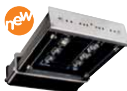
Proiettori LED da galleria per illuminazione di rinforzo con ottica asimmetrica controflusso IP66
